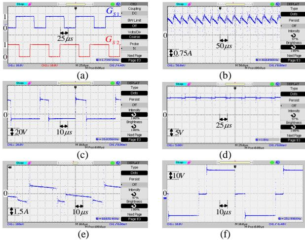
Fig. 8. Key waveforms for  $N = 1$  in SOD; (a) Trigger pulses; (b)  $i_{L1}$ ; (c)  $v_{L1}$ ; (d)  $v_{C1}$ ; (e)  $i_{C1}$ ; (f) Output load voltage.
